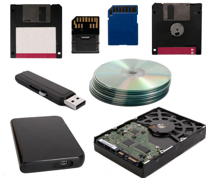
Figura 14: Dispositivos de armazenamento: disquetes, cartão SD, pen drive, CD-Room, HD externo, disco rígido (HD interno)
