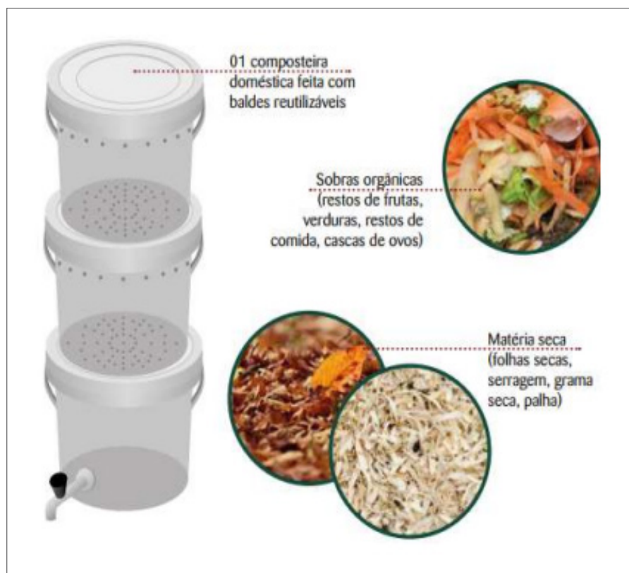
FIGURA 1 – Representação de uma composteira caseira [5].
