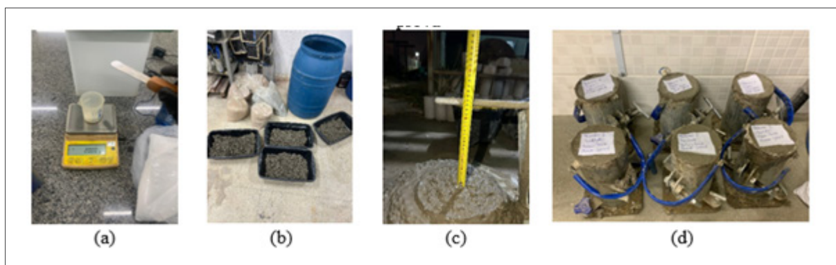
FIGURA 1 – Procedimentos experimentais utilizados no estudo. (a) Pesagem de materiais, (b) Produção dos agregados reciclados, (c) Ensaio de abatimento do tronco do cone, (d) Moldagem de corpos de prova
