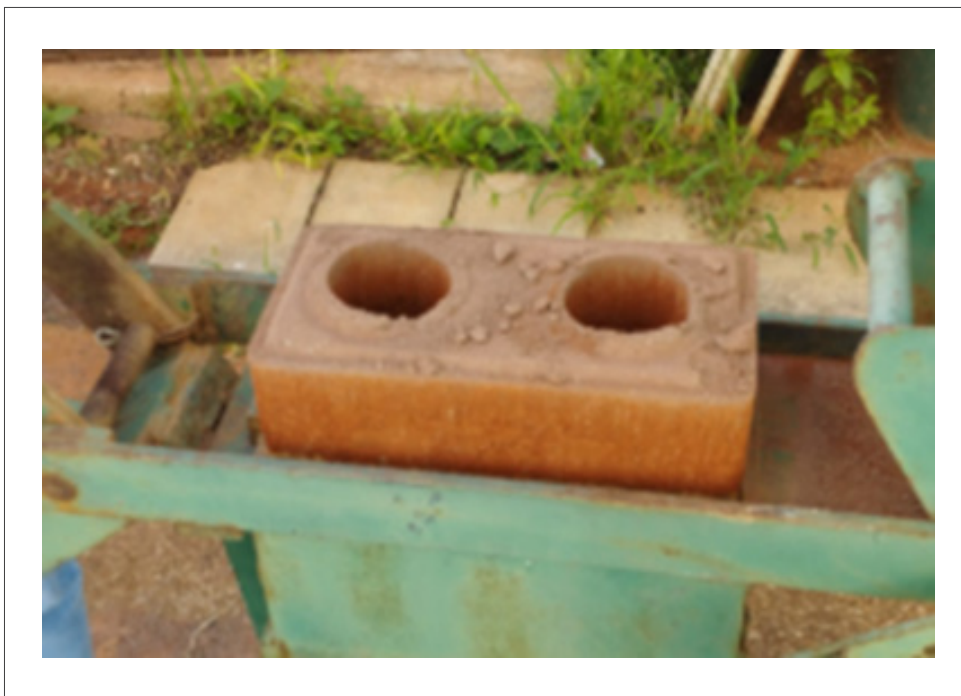
(b) Tijolo Ecológico produzido no IFB com Solo-Cimento (b)
